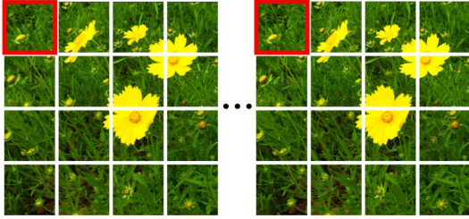
图2 不同视点相同位置的图像块的注意力计算示意图 Fig. 2 Schematic diagram of attention computation for image patches at the same position for all sub-views
